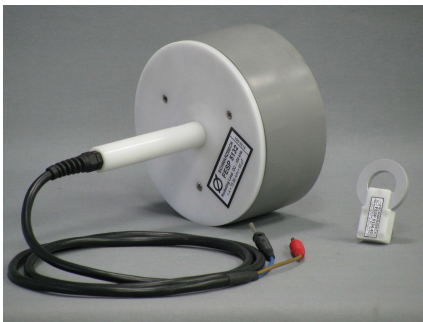
図 1: 120 mm 放射ループ (左) とベリフィケーション用 40 mm センサ・ループ (右) の例 (写真は Schwarzbeck 社の厚意による)
