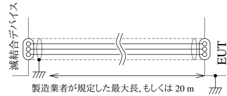
図 14: シールド線の接地への接続
